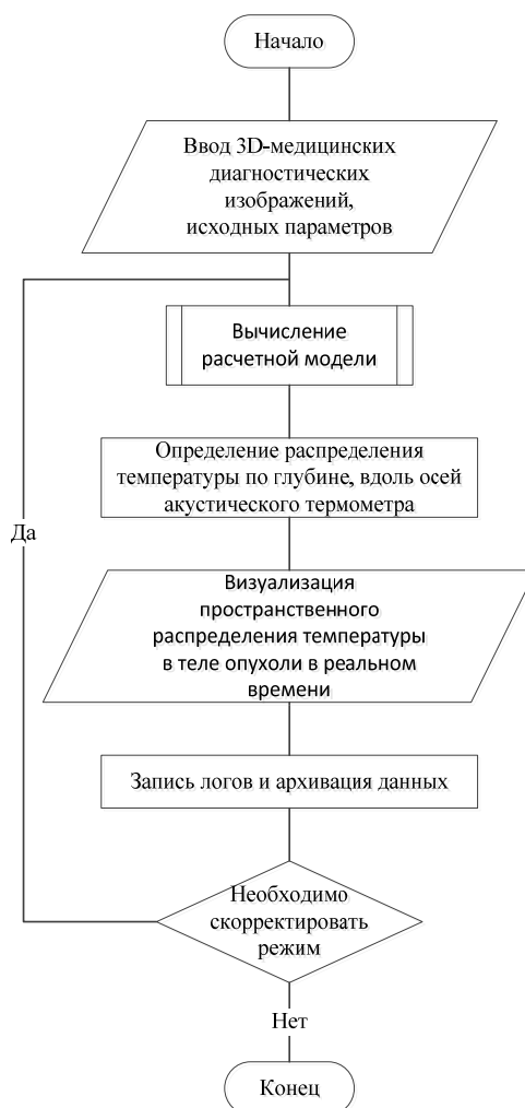
Рис. 1. Алгоритм работы программы компьютерного управления лазерной терапией
