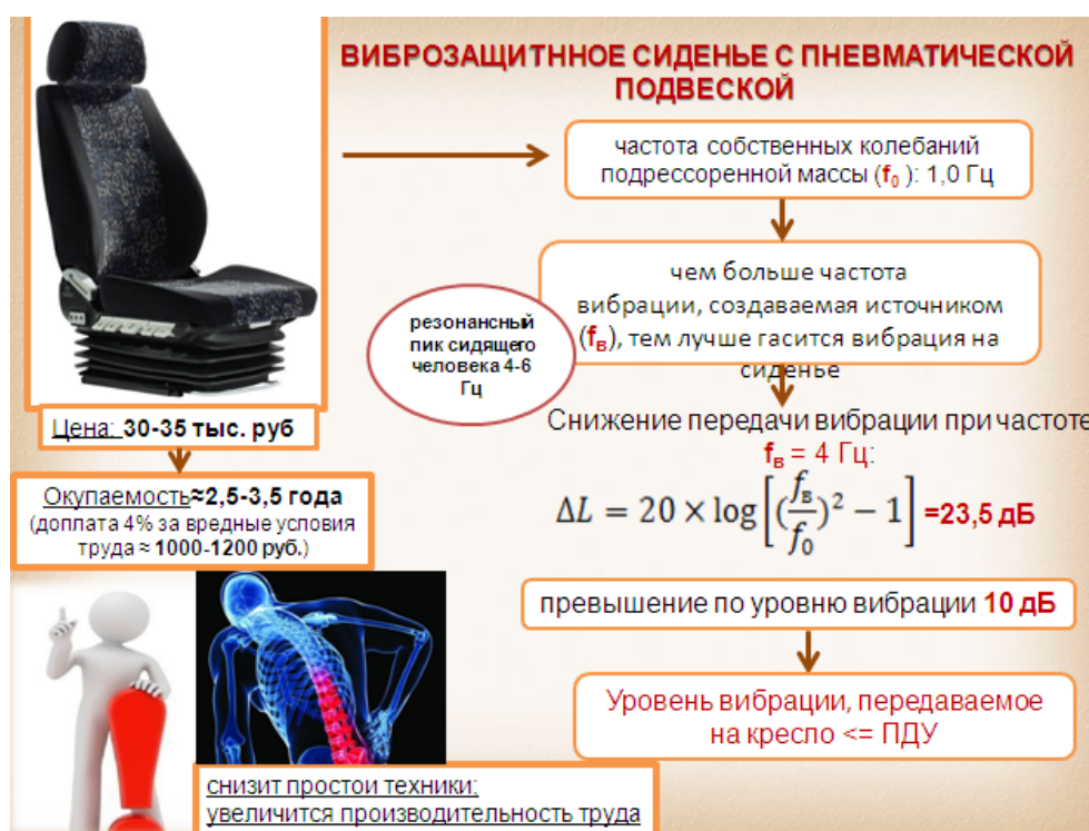
Рис. 15. Виброзащитное сиденье с пневматической подвеской для снижения вредного воздействия вибрации
