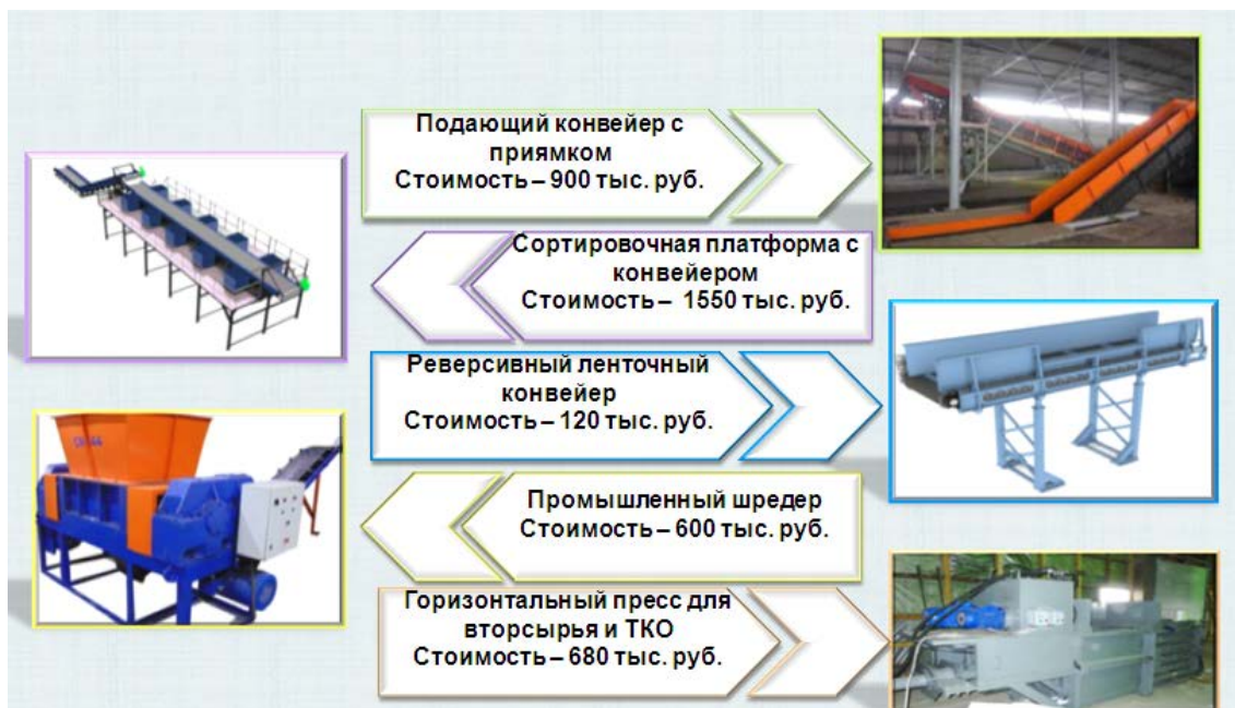
Рис. 12. Основное оборудование мусоросортировочного комплекса
