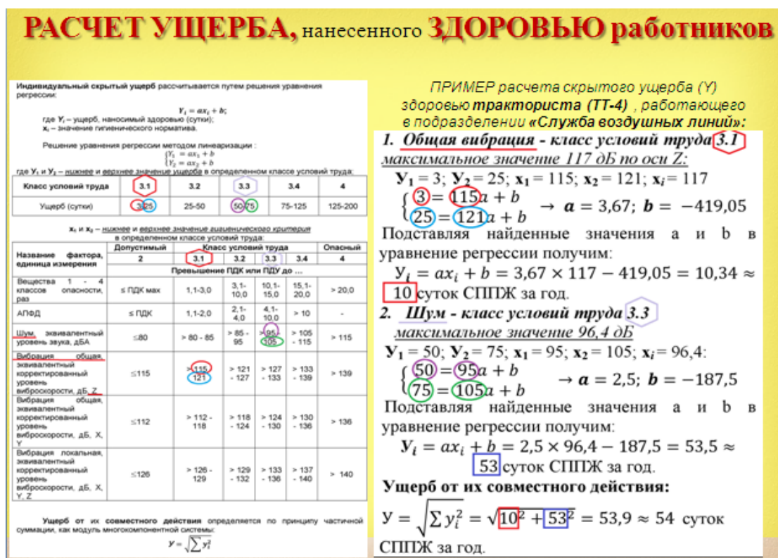
Рис. 13. Расчет ущерба, нанесенного здоровью работников службы воздушных линий, воздействием на них вредных и опасных факторов
