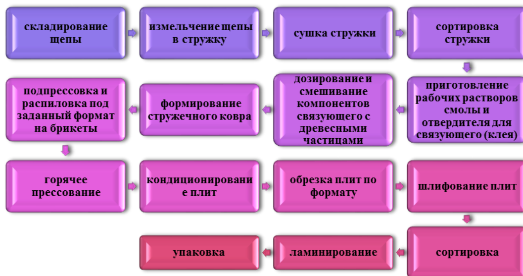
Рис. 3. Схема производства древесно-стружечных плит в ООО «СФЗ»
