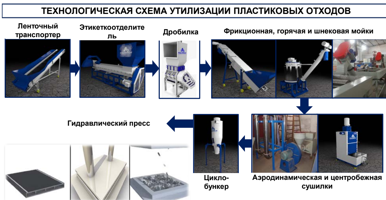
Рис. 4. Технологическая схема утилизации пластиковых отходов
