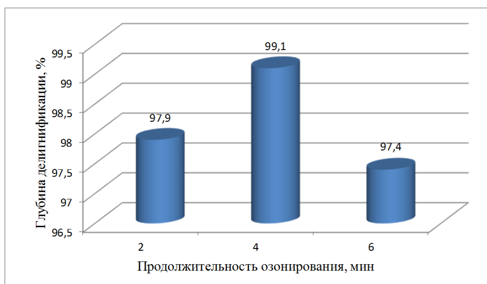
Рис. 1. Показатели глубины делигнификации хвойной целлюлозы при различной продолжительности озонирования
