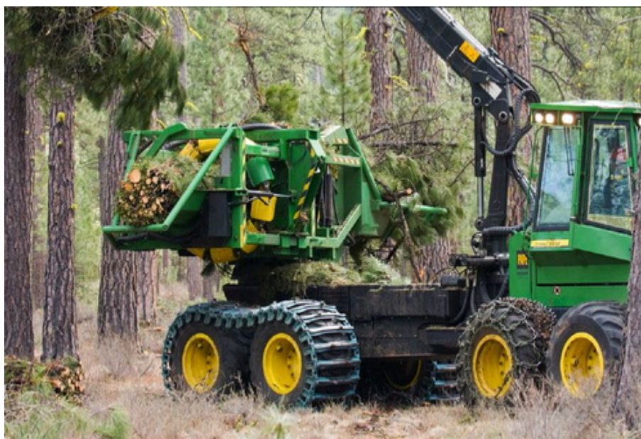
Машина для пакетирования порубочных остатков John Deere 1490D
