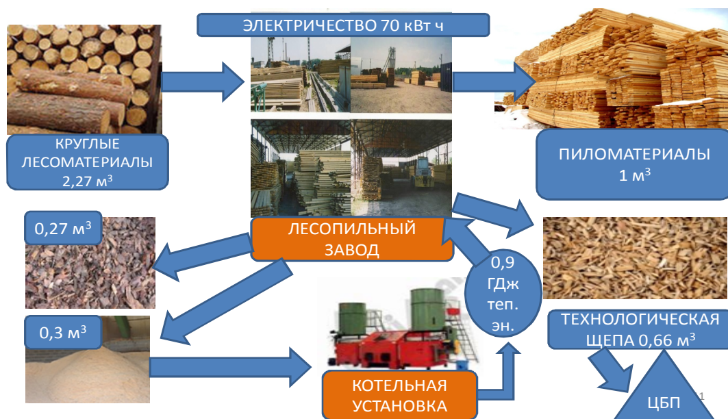
Рис. 3. Материальный и топливно-энергетический баланс типичного лесопильного завода в расчете на 1 м 3 сухих пиломатериалов
