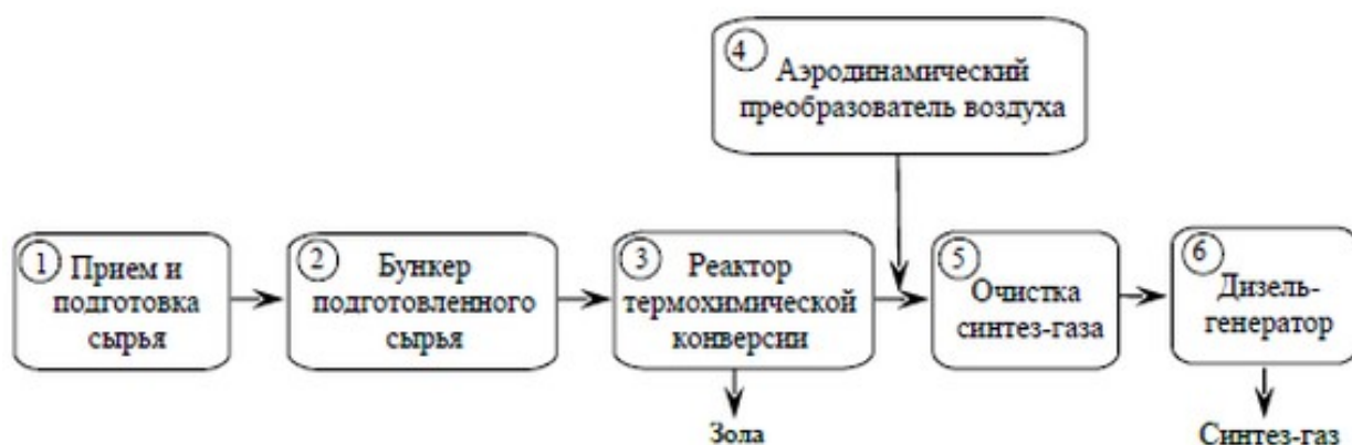
Рис. 6. Схема по утилизации древесных отходов и получению синтез-газа
